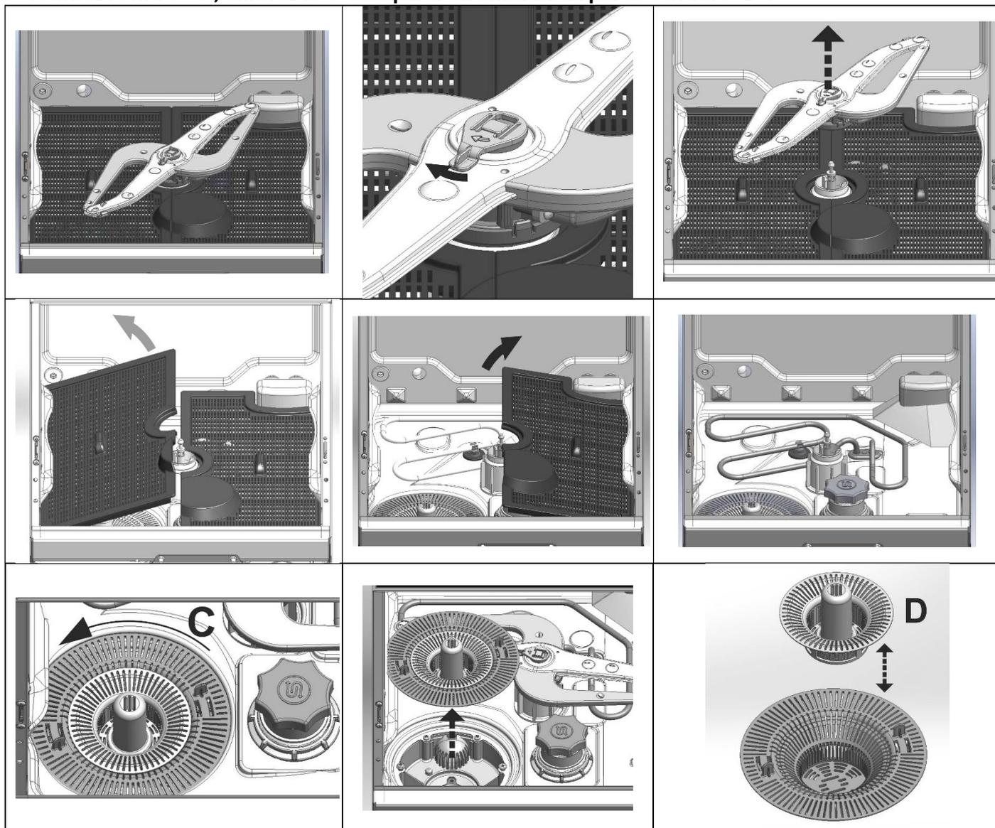
**Procédure de démontage des filtres avec 2 éléments filtrants:**
