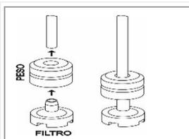
Avant d'installer les tuyaux dans les distributeurs, lester les extrémités avec le poids (nécessaire pour garder l'aspiration sur le fond du distributeur) et monter le filtre, comme montré sur la figure. Si le doseur de détergent n'est pas monté en usine, il suffit de commander le KIT correspondant pour pouvoir l'installer.
