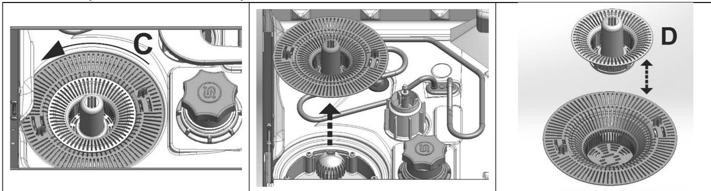
Retirant les filtres, évitez que les grosses granules tombent dans la partie sous les filtres, nettoyer des résidus et rincer abondamment puis insérez les correctement; ne pas intervenir avec des objets tranchants.
