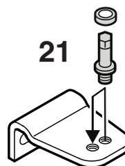
21. Retirer le pivot du support et l'introduire dans l'orifice opposé.
