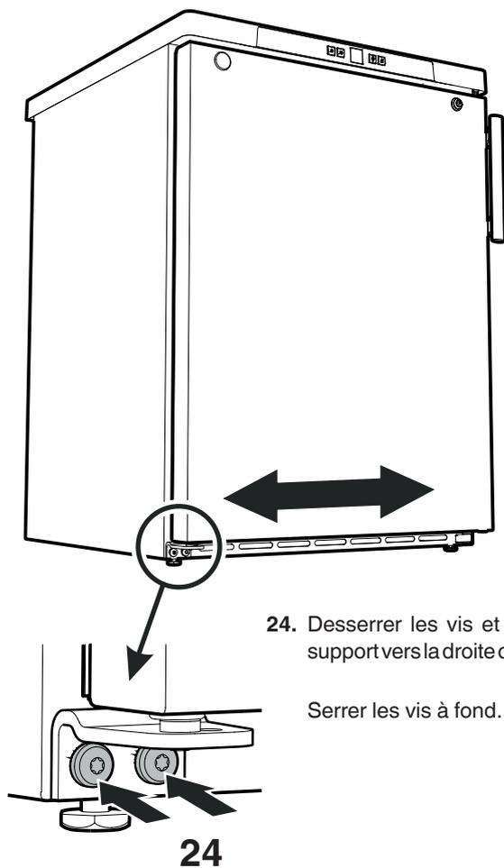
24. Desserrer les vis et déplacer le support vers la droite ou la gauche.
