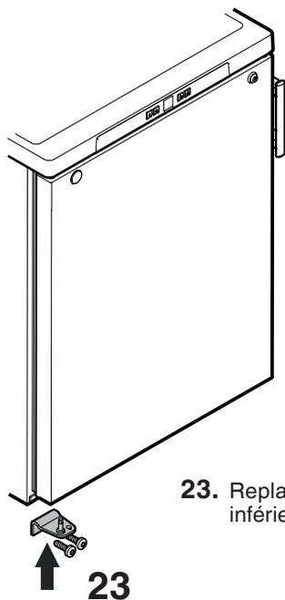
23. Replacer le support dans le palier inférieur de la porte et le visser.
